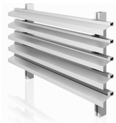
Celosía Gradpanel Serie CL 70 de lamas de aluminio extruido de alta calidad. Material apropiado por su óptima resistencia a la intemperie, aceptando una gran cantidad de acabados tanto en anodizados como en colores de la gama RAL. Sección de lama de 70 x 50 mm. Reparto de lamas variable en función de las necesidades de proyecto. Su colocación es ideal para crear paramentos continuos de lamas no condicionadas a modulación, combinando ocultación, protección solar y ventilación.
