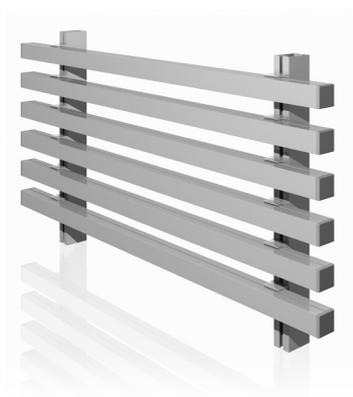
Celosía Gradpanel Serie CL 35 de lamas de aluminio extruido de alta calidad. Material apropiado por su óptima resistencia a la intemperie, aceptando una gran cantidad de acabados tanto en anodizados como en colores de la gama RAL. Sección de lama de 35 x 35 mm. Reparto de lamas variable en función de las necesidades de proyecto. Su colocación es ideal para crear paramentos continuos de lamas no condicionadas a modulación, combinando ocultación, protección solar y ventilación.
