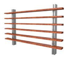
Celosía Gradpanel Serie CL Mad 50 de de lamas fijas de madera maciza de cedro rojo, procedente de la costa oeste de Canadá, en posición horizontal o vertical para diferentes aplicaciones. Sección de lama 15 x 50 mm. Acabado Natural.
