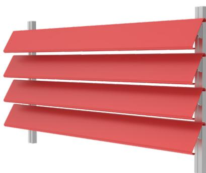
Celosía Phalsol Serie C 100 de lamas de aluminio extruido de alta calidad fijas (30° y 45°). Material apropiado por su óptima resistencia a la intemperie, aceptando una gran cantidad de acabados tanto en anodizados como en colores de la gama RAL. Sección de lama de 100 x 15 mm.
