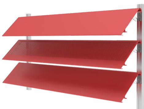
Celosía Phalsol Serie C 180 de lamas de aluminio extruido de alta calidad fijas (45°, 30°, 0°) y orientables. Material apropiado por su óptima resistencia a la intemperie, aceptando una gran cantidad de acabados tanto en anodizados como en colores de la gama RAL. Sección de lama de 180 x 20 mm.
